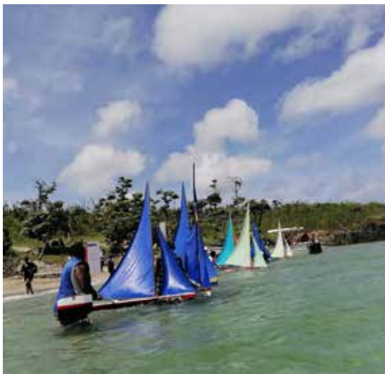
Die Schiffsmodelle sind aus dem Holz des Woll- oder Kapokbaums gefertigt und segeln selbststeuernd ihren Kurs.
